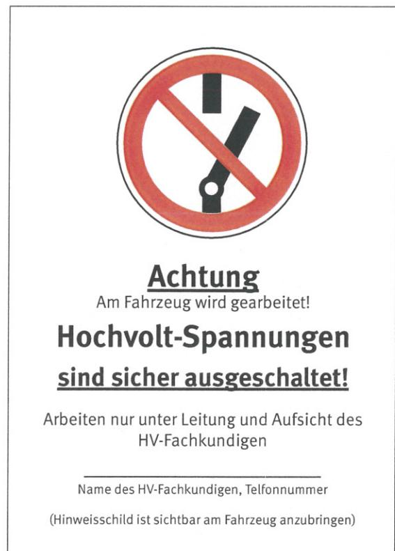
Bild 6: Kennzeichnung von HV-Fahrzeugen in der Werkstatt
