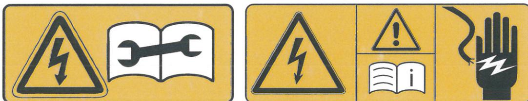
Bild 9: Beispiele für die Kennzeichnung von HV-Komponenten
